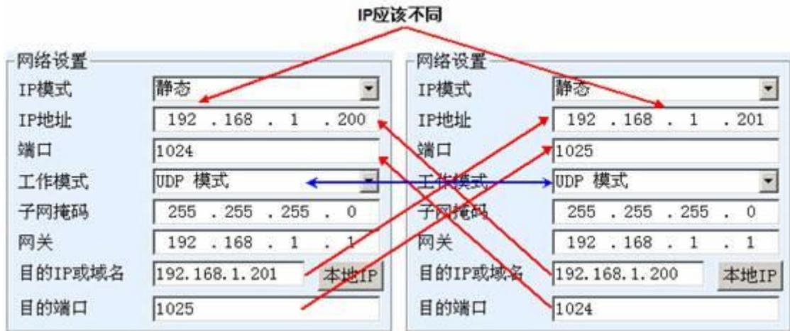
picture21 UDPDevice couplet parameter configuration
