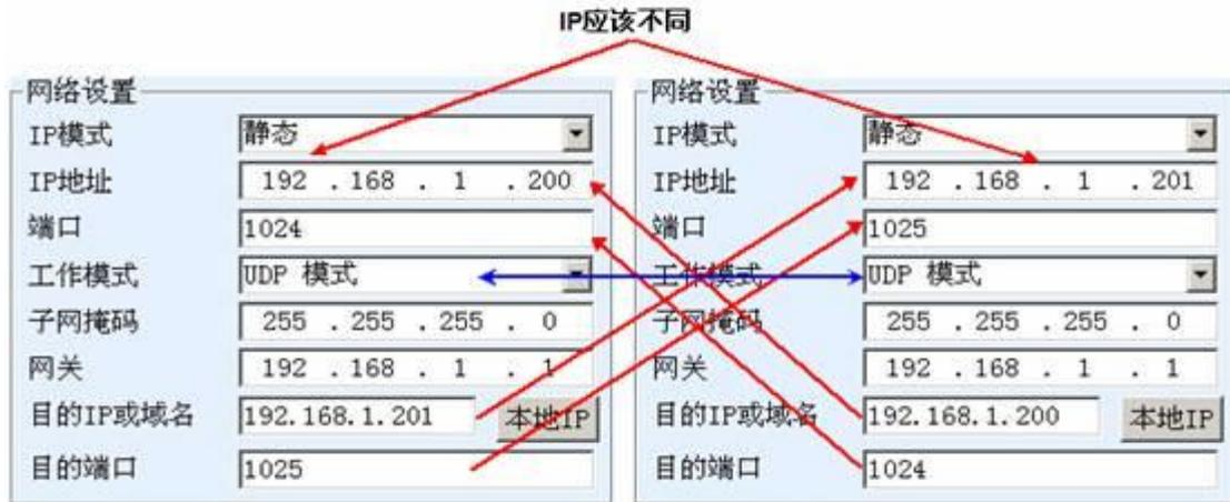
picture19 TCPDevice couplet parameter configuration
